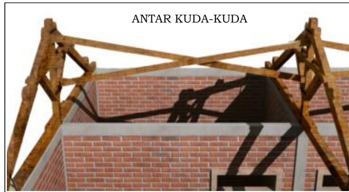
Gambar 34. Ikatan Angin Sebagai Pengikat Antar Kuda-Kuda Kayu
