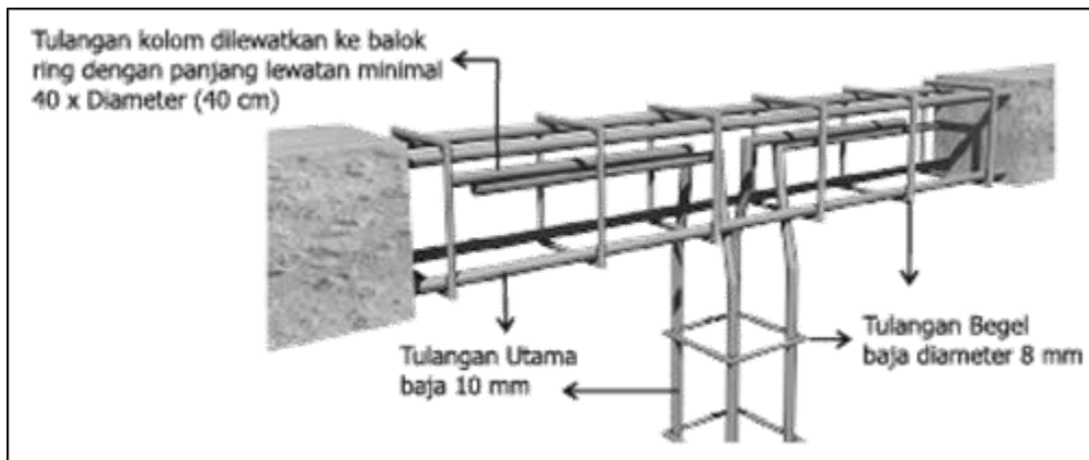
Gambar 48. Hubungan Anatar Kolom dengan Balok Keliling/ Ring
