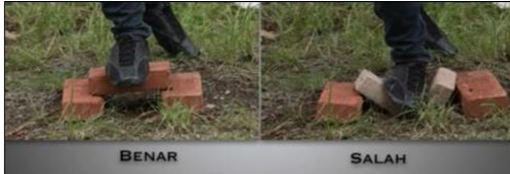
Gambar 13. Pengujian Sederhana Kekuatan Batu Bata
