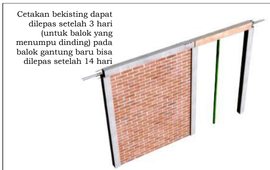
Gambar 61. Pelepasan Cetakan/ Bekisting
