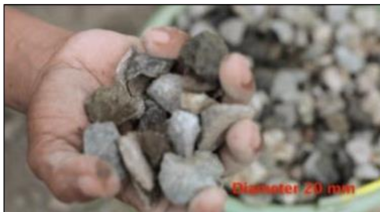
Gambar 5. Diameter Kerikil Yang Baik Untuk Campuran Beton
